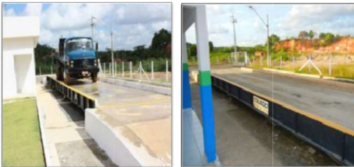
Foto 2- Pesagem do veículo em balança rodoviária
