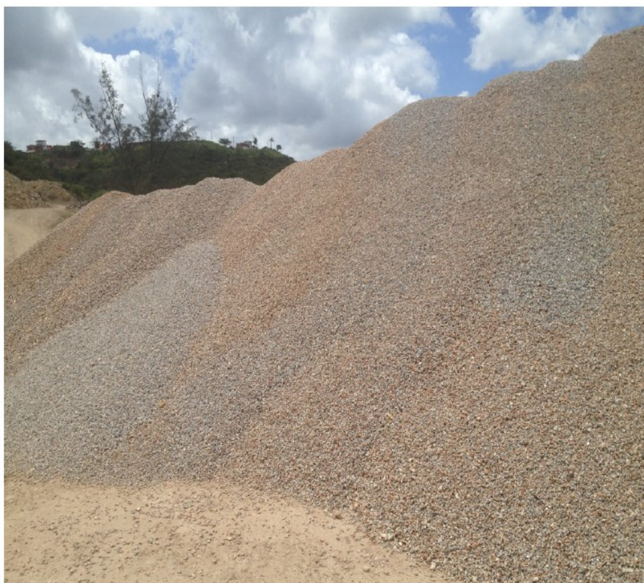
Foto 6 - Pátio de estocagem dos agregados reciclados Fonte: Plano de Gestão Integrada de Resíduos Sólidos da empresa Ciclo Ambiental
